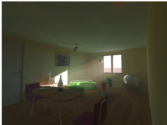
FIGURE 2.22 – Dans cette scène, seul l'éclairage naturel (modèle de ciel clair standard CIE), avec du soleil, est présent.
