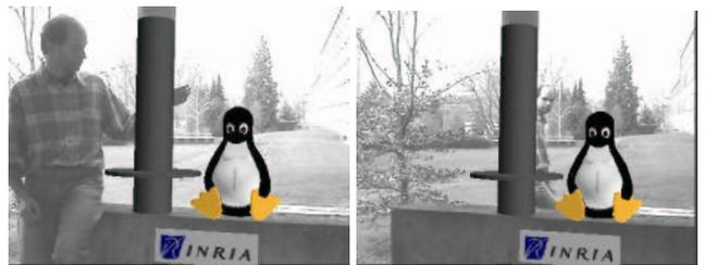
FIG. 6 – Suivi en utilisant un cylindre et deux lignes droites. Une application à la réalité augmentée.
