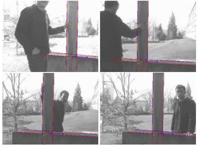
FIG. 5 – Suivi dans un environnement d'extérieur. Malgré des occultations multiples et des perturbations, le suivi est toujours très fiable et est géré en temps réel.
