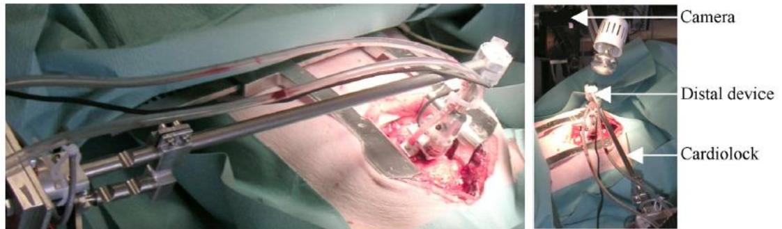
FIG. 1.12 – Le système Cardiolock [Bachta 2008] est positionné sur le cœur d'un cochon pour une compensation active des battements cardiaques.
