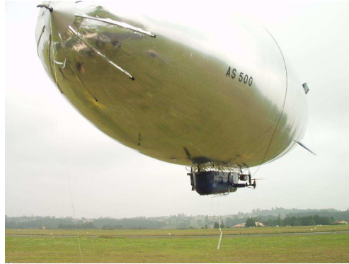
FIG. 1.12 – Le dirigeable Karma du LAAS (8 m de long, 15 \text{ m}^3 , 1.90 m de diamètre max.).
